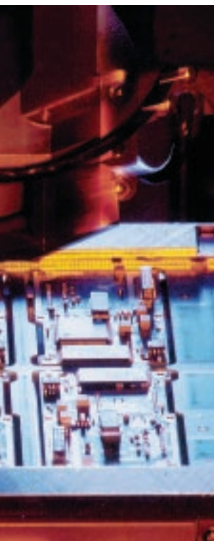
SIMATIC S7-400 con módulo de aplicación FM 458-1 DP, High-Speed Boolean Processor FM 352-5
